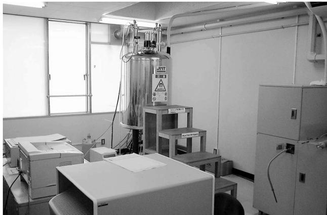
本核磁気共鳴装置の目的は、溶液状態にある物質の静的な構造・組成や動的な分子挙動に関する情報を得るものです。化学反応における原料物質や生成物質の核磁気共鳴分光信号の増減から、物質の変換に関する情報も得ることができます。本装置は、11.74テスラの磁場強度を持ち、有機化合物を構成する主要核種だけでなく $^{31}\text{P}$ ～ $^{15}\text{N}$ 間で共鳴する様々な核種について、その信号の自動調整最適化を短時間で行うことができます。水素核側から炭素核情報を得るHMQC法や、ロングレンジ結合情報を得るHMBC法は微量物質測定に必須ですが、本装置ではプローブ変換をすることなく、 $^1\text{H}$   $^{13}\text{C}$  C-HCOSY HMBC/HMQC全自動測定することができます。また、大気中より窒素ガスを分別液化し、超電導磁石に自動供給する機能を持つため、維持効率が著しく高くなっています。
