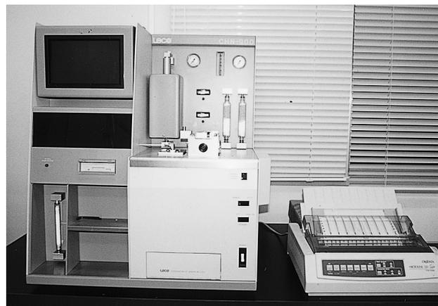
本装置は、合成された新規物質の炭素、水素、窒素の割合を測定し、理論値と比較することによって、物質組成を同定する目的に用います。本装置(レコ CHN-900)は、炭素・水素を赤外吸収法により、窒素を熱伝導度により個々に検出しており、精度の高い分析が迅速にかつ正確に行えます。要求される試料重量は1.5ミリグラム程度と非常に微量であり、1回の測定には約3分を要しますが、分析精度は炭素が0.2%以下、水素が0.1%以下、窒素が0.1%以下と、非常に高精度です。
