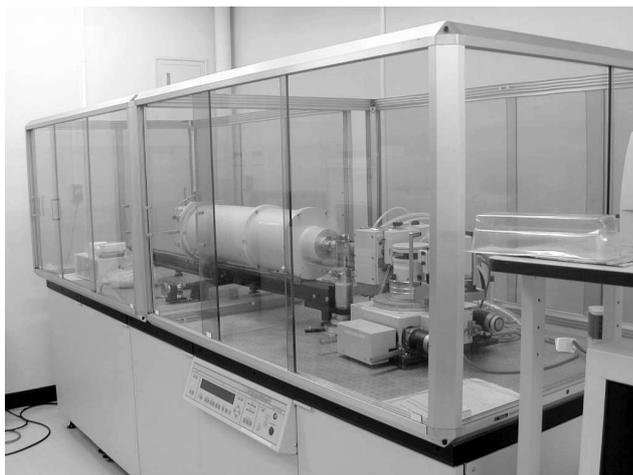
本装置は回転対陰極を用いた強力なX線源を用い、小角から広角にわたるX線散乱・回折測定により、物質の構造を解析するものです。広角領域での測定では、粉末や薄膜試料について、格子定数、配向などの測定が行えます。また、小角X線散乱では、多層膜ミラー光学系を採用することによって、分解能の高い計測が可能で、散乱体の大きさや形状が評価できます。
